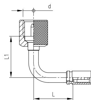
**90° Schraubanschluss S12.65 x 1.5**
