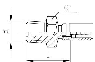
**Kegelanschluss mit Außengewinde**
