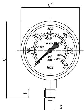
**Anschluss unten****Bottom connection****Abmessungen / Dimensions**
