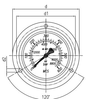
**Rückseitiger Anschluss mit Flansch****Back connection with front fixing flange****Abmessungen / Dimensions**
