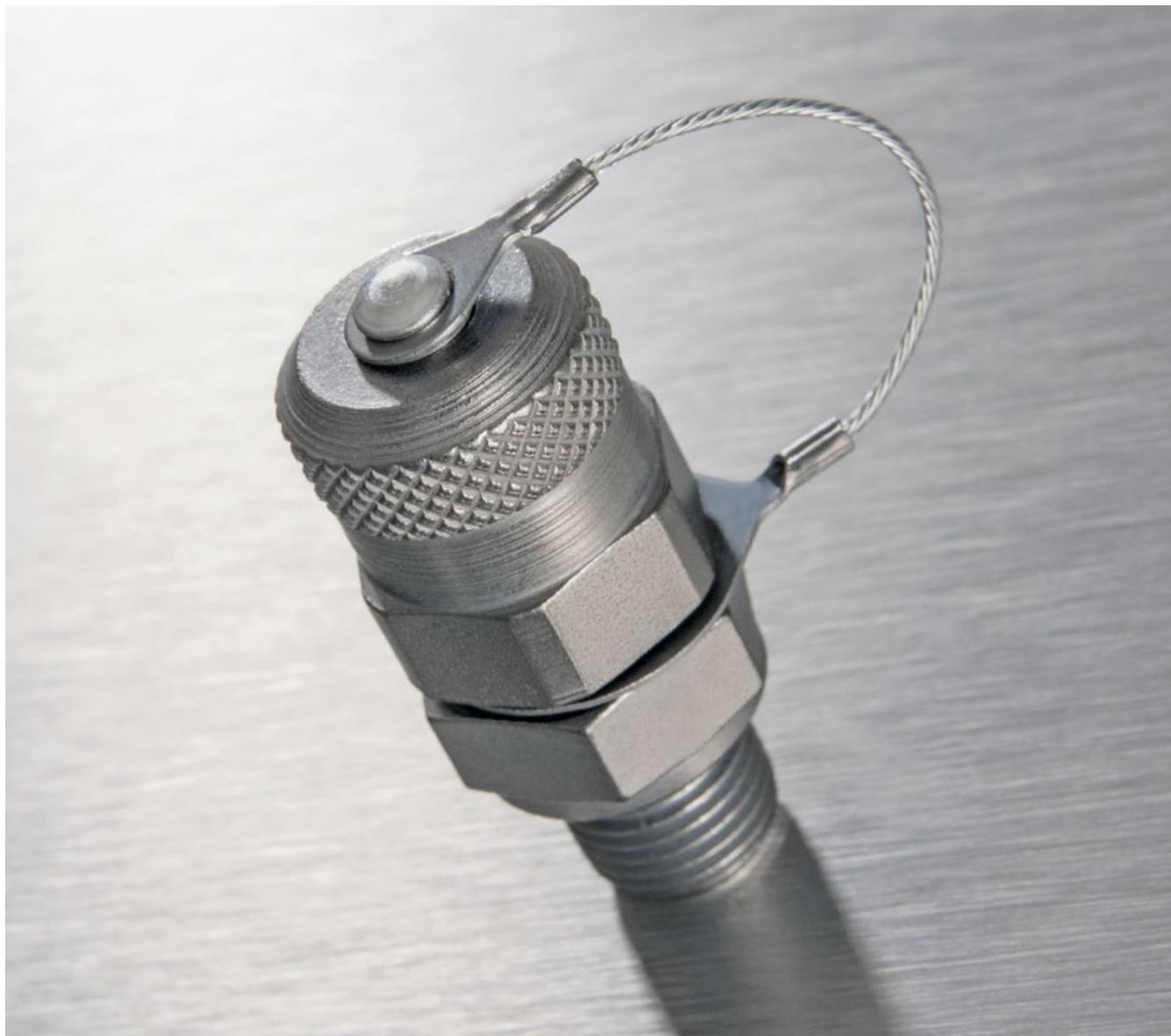
Die neue Messkupplung der Serie MCS® 621 ist eine zuverlässige und leckagefreie Lösung, auch bei Flüssigkeiten mit sehr niedriger Viskosität. Das sechseckige und selbstzentrierende Tellerventil mit 6 Abschnitten für den Durchfluss und O-Ring, reduziert Druckverluste und sorgt für ein schnelleres Ansprechen und präzisere Messungen.
