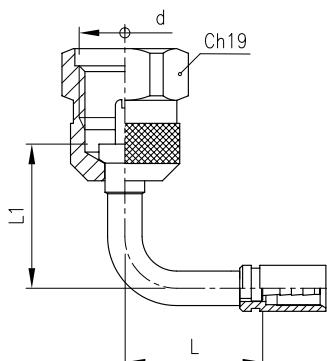
**90° Schraubanschluss M16 x 2**
