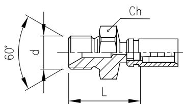
**BSP-Anschluss mit 60° Außengewinde, konisch**
