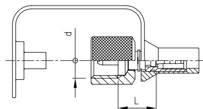
**Schraubanschluss S12.65 x 1.5**
