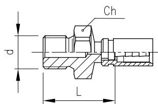
**Flacher BSP-Anschluss mit Außengewinde**
